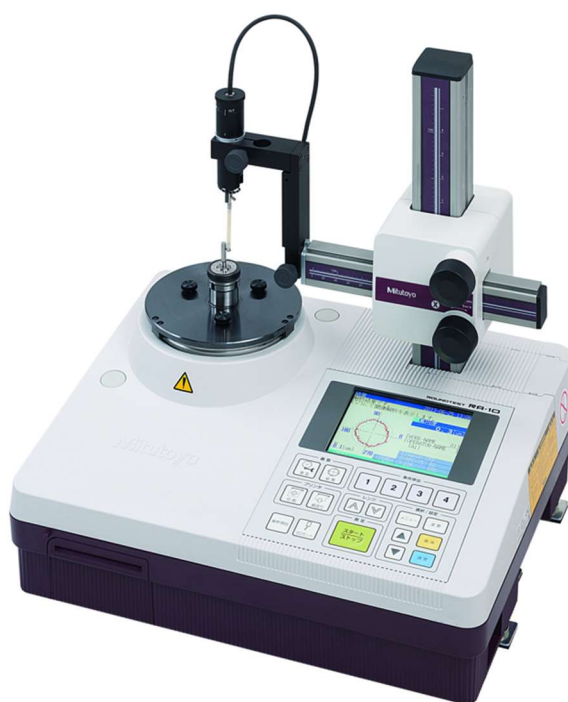
Obr. 3.18 Dílenský kruhoměr Mitutoyo RA-10 [17].
