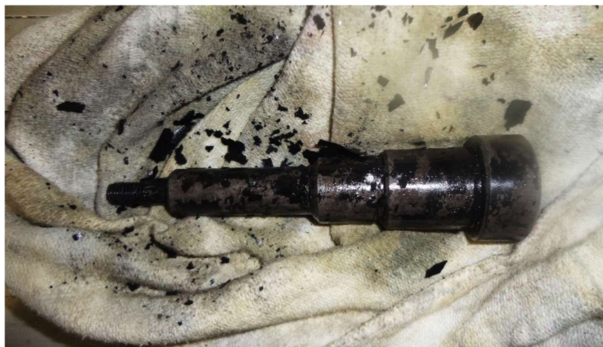
Obr. Součást po kalení.
