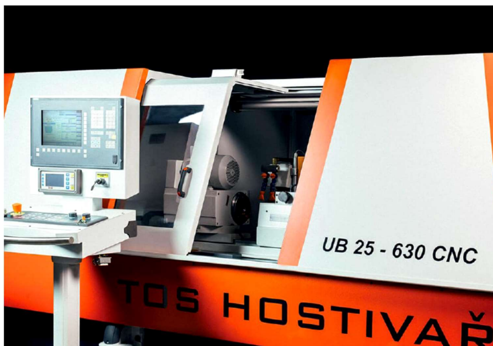
Obr. 3.5 Hrotová bruska UB 25-630 CNC [11].
