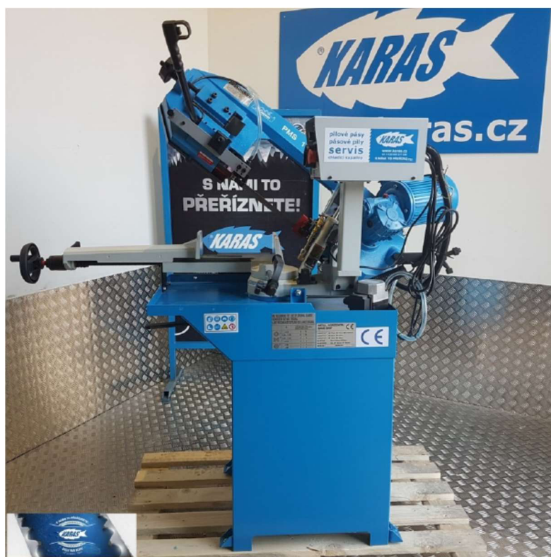
Obr. 3.1 Pásová pila Pilana PMS 170/210 MO [8].
