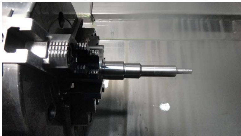
Obr. Součást po obrobení z jedné strany.
