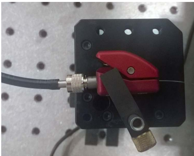
Obr. 3.19: Dočasný konektor BFT1 s koncovkou SMA905 napojený na rozvod stlačeného dusíku.
