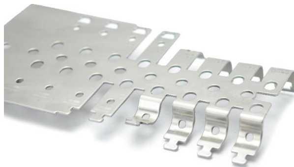
Obr. 29 Výrobek zhotovený v postupovém sdruženém nástroji. [29]
