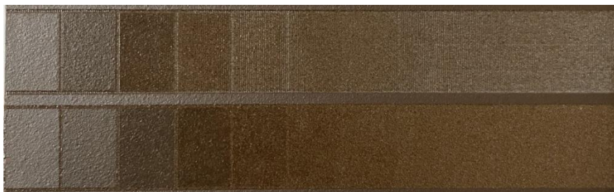
Obrázek 38 Test gravírování na keramické dlažbě
