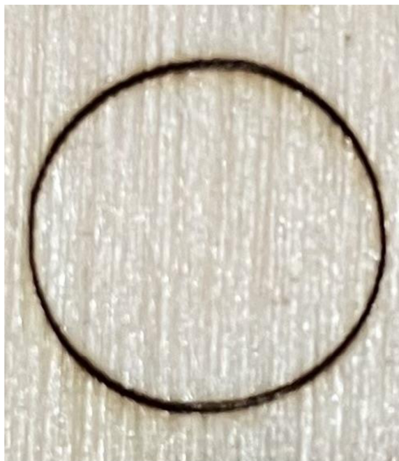
Obrázek 24 Přesný kruh o průměru 10 mm
