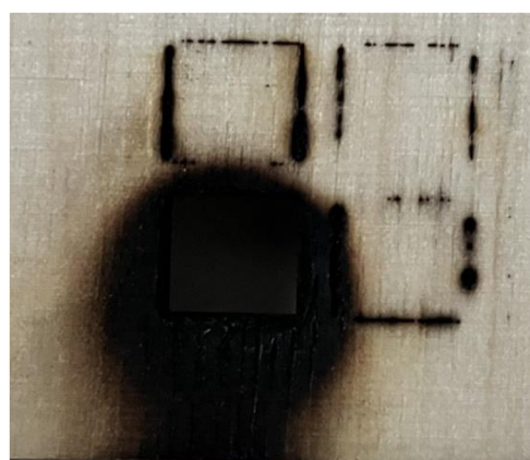
Obrázek 29 Opal březové překližky (6,5 mm)
