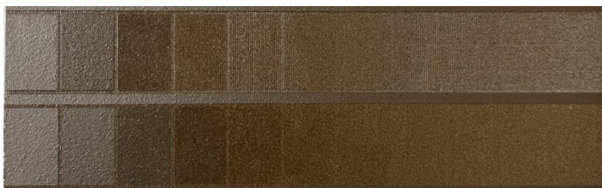
Obrázek 38 Test gravírování na keramické dlažbě
