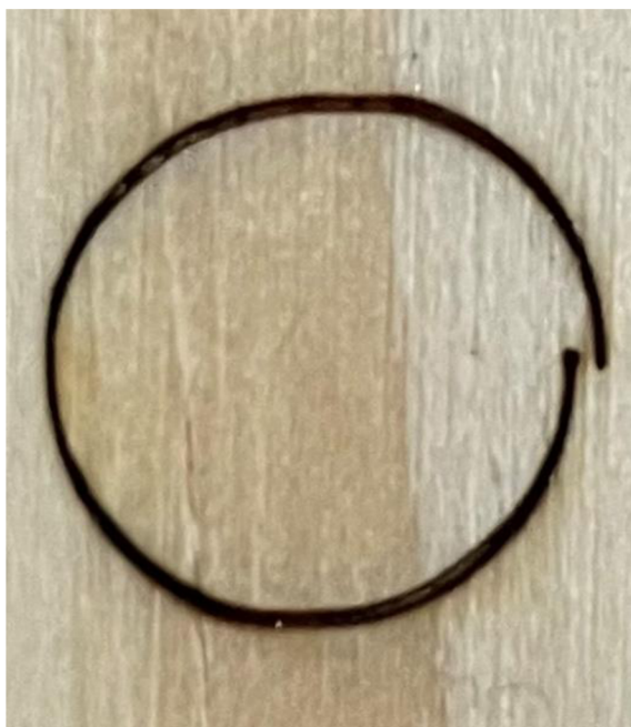
Obrázek 23 Nepřesný kruh o průměru 10 mm
