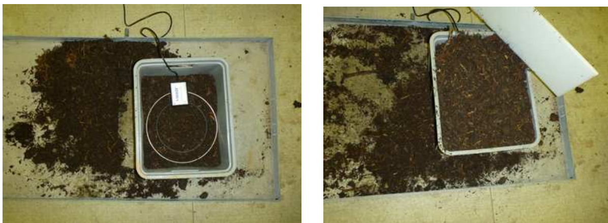
Obr. 14: Ukládán substrátu kompostu se snímačem Virrib
