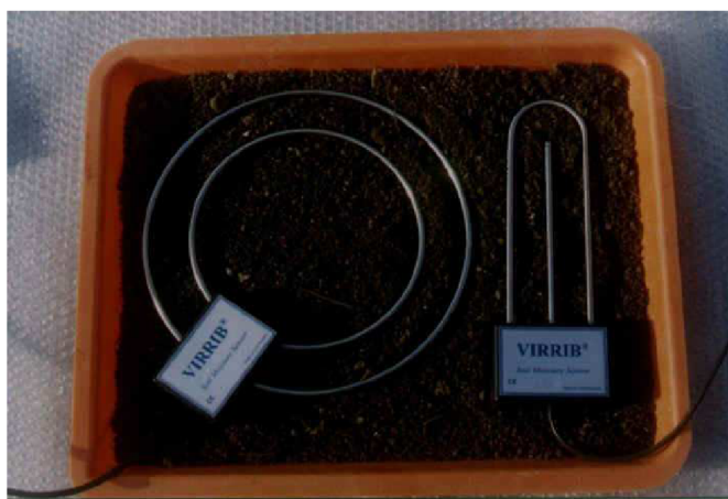
Obr. 13: Snímač objemové vlhkosti půdy Virrib – kruhová varianta (vlevo), podlouhlá (vpravo)
