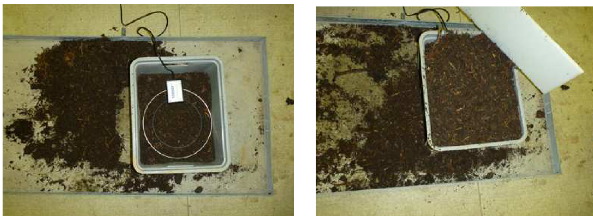
Obr. 14: Ukládán substrátu kompostu se snímačem Virrib
