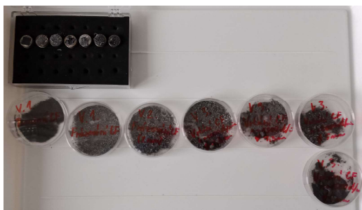
Obrázek 2.12: Nevypálené vzorky s epoxidovou pryskyřicí.
