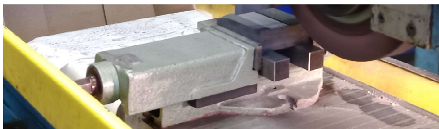
Obrázek 2.9: Vyobrazení technologie broušení laminátové desky z CFRP.
