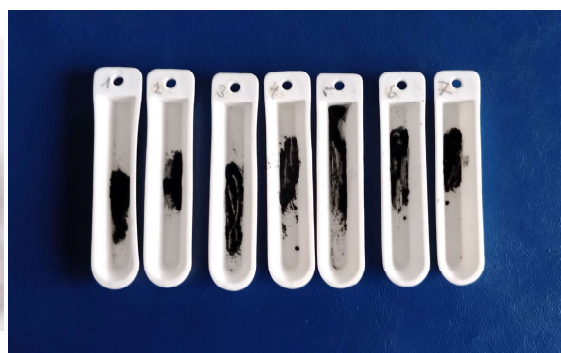
Obrázek 2.13: Vypálené vzorky bez epoxidové pryskyřice.
