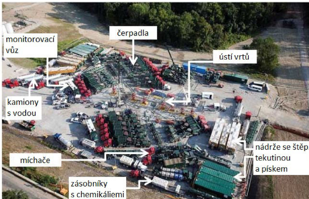
obr. 3-2 Hydraulické štěpení v současnosti v Pensylvánii ve formaci břidlic Marcellus [18]
