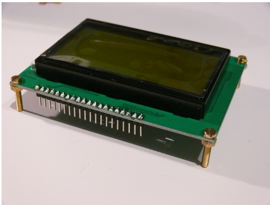
Obrázek A.16: Zapájený oboustranný kolík do displeje a spojovací šrouby
