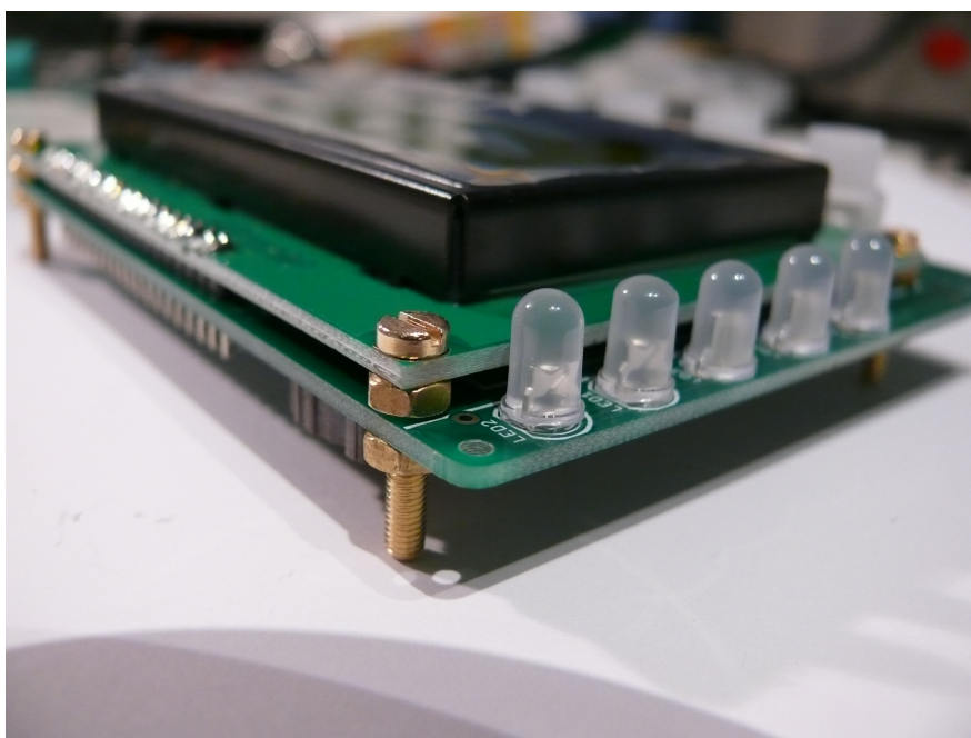
Obrázek A.17: Ukázka montáže displeje na základnovou stanici
