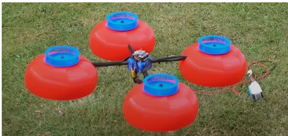
Obrázek 32: Testovací dron s Coanda tryskami [17]
