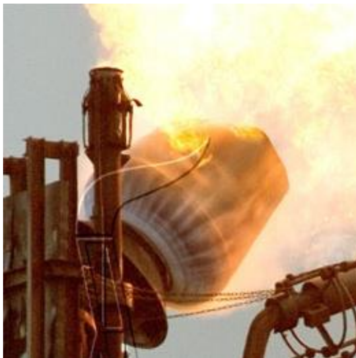
Obrázek 37: Zažehnutý Coanda hořák [19]
