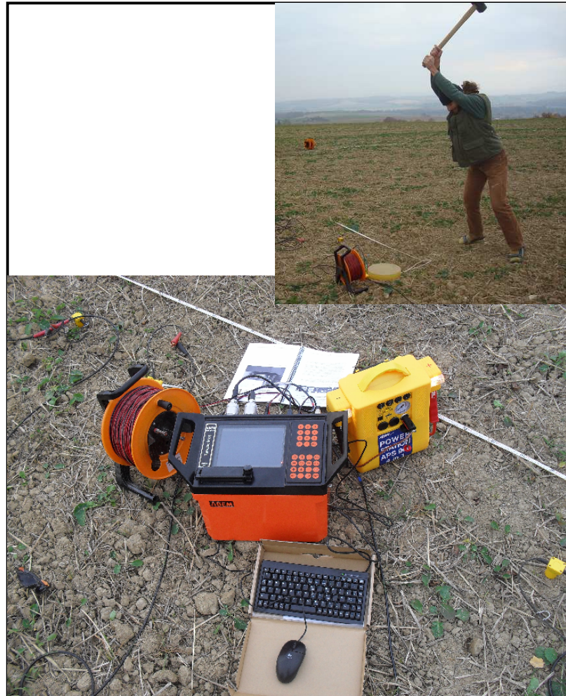
Příloha 3: fotografie přístroje ARES - vlevo a ABEM Terraloc Mk8 - vpravo; foto P. Dlešík
