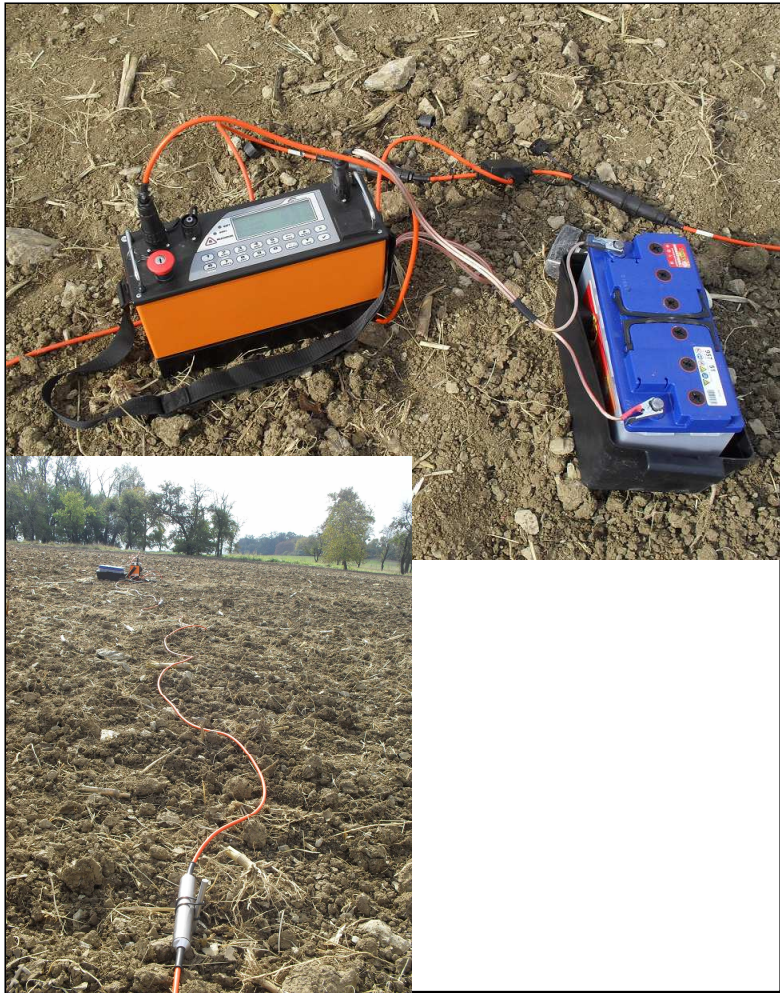
Příloha 3: fotografie přístroje ARES - vlevo a ABEM Terraloc Mk8 - vpravo; foto P. Dlešík
