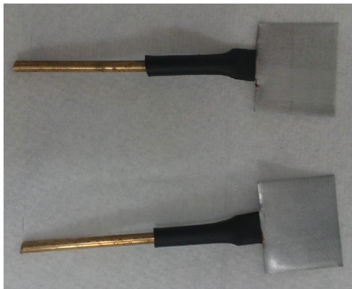
Obr. 3. 3 Očištěné Sn elektrody po vytvrzení lepidla, připravené pro depozici.
