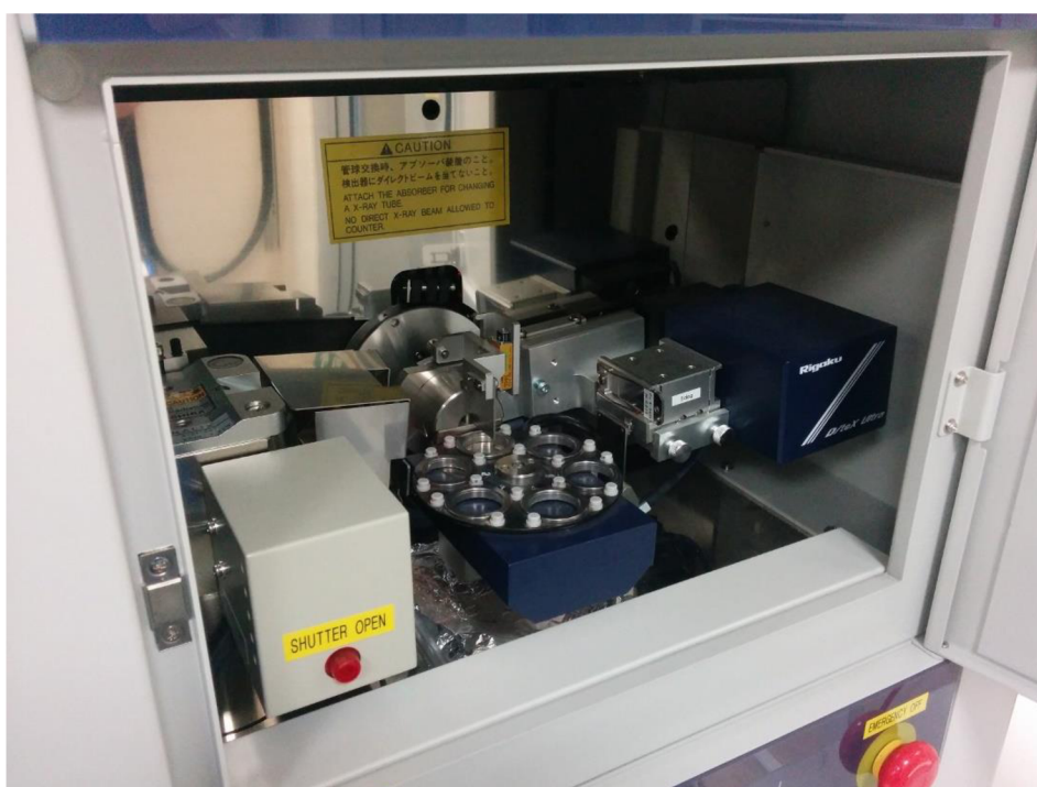
Obr. 2.3 Vnitřní uspořádání rentgenového difraktometru Rigaku Miniflex 600 HR. Převzato z [25].
