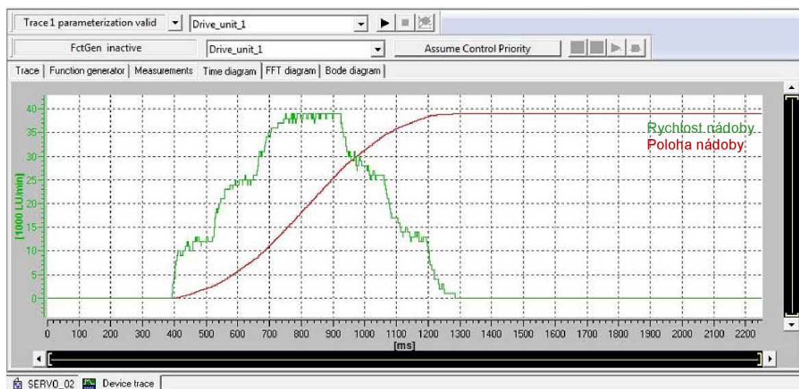
Obr.54 Nejrychlejší možný případ pohybu nádoby v programu STARTER
