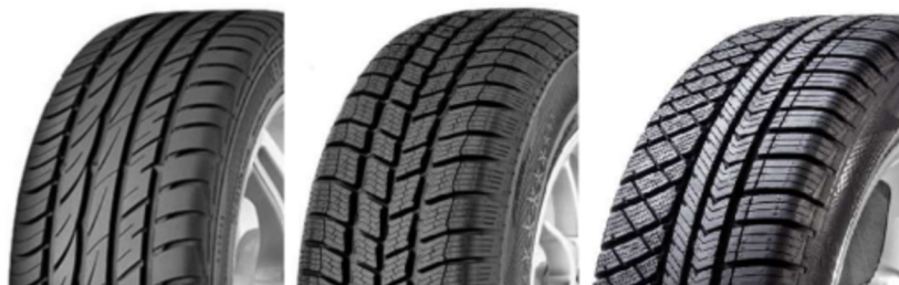
Obrázek 14 - letní, zimní a celoroční dezén pneumatik [18]
