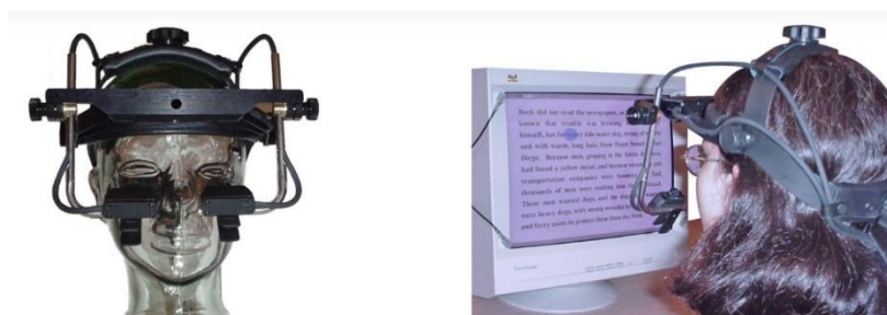
Obrázek 4: Mobilní eye-tracker EyeLink II od společnosti SR Research s videokamerou 4
