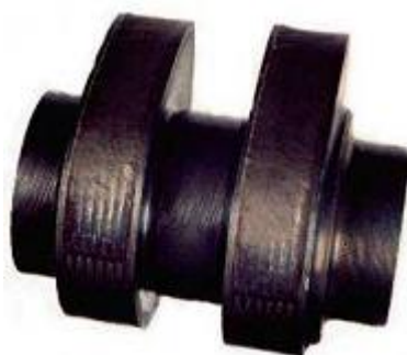
Obr. 24 Šedá litina 422425, přetavená hloubka 1 mm, povrchová tvrdost 60 HRC [20]
