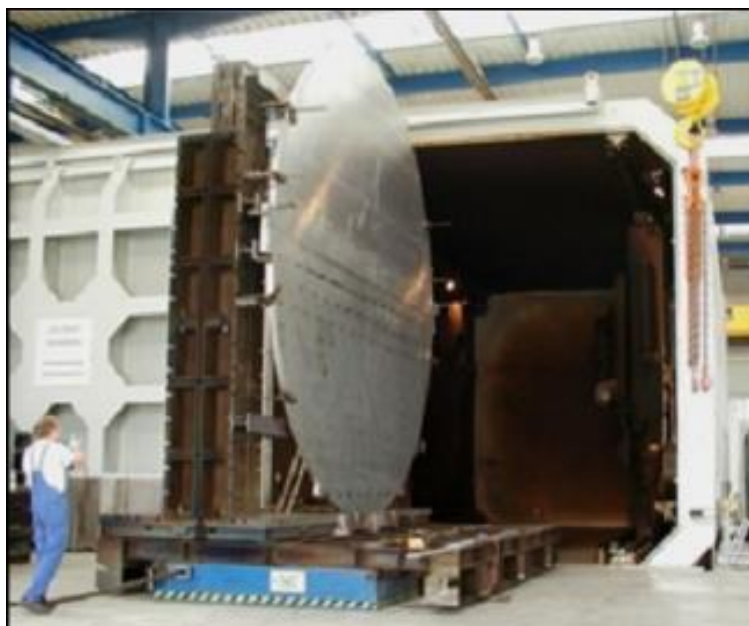
Obr. 13 Pracovní komora K6000-1 firmy Pro-Beam s objemem 640 \text{ m}^3 [20]
