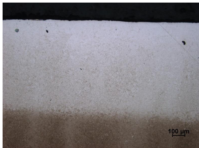
Obr. 93 Vzorek 6, oblast 6.1, struktura zakalené povrchové vrstvy, zvětšeno 100x
