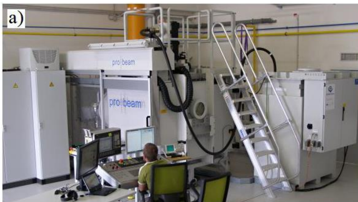
Obr. 30 Zařízení Probeam K26 pro operace využívající elektronového svazku [16]
