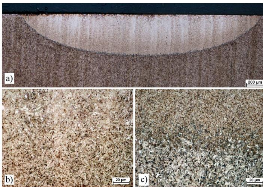
Obr. 43 Snímky zakalené povrchové vrstvy oceli 2 tvořené martenzitickou strukturou [16]
