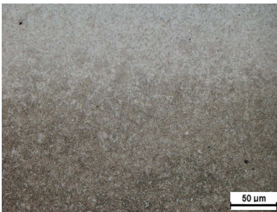
Obr. 63 Vzorek 1.9, rozhraní zakalené vrstvy a základního materiálu, zvětšeno 500x
