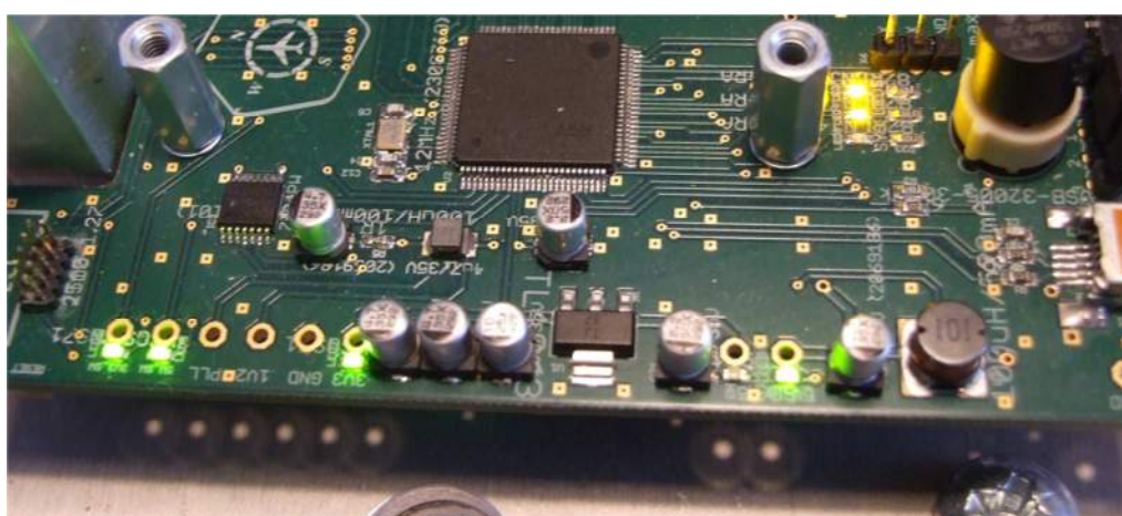
Obrázek 3.38 Detail LED zobrazujících stav napájecích linek (zelené) i uživatelských (žluté)
