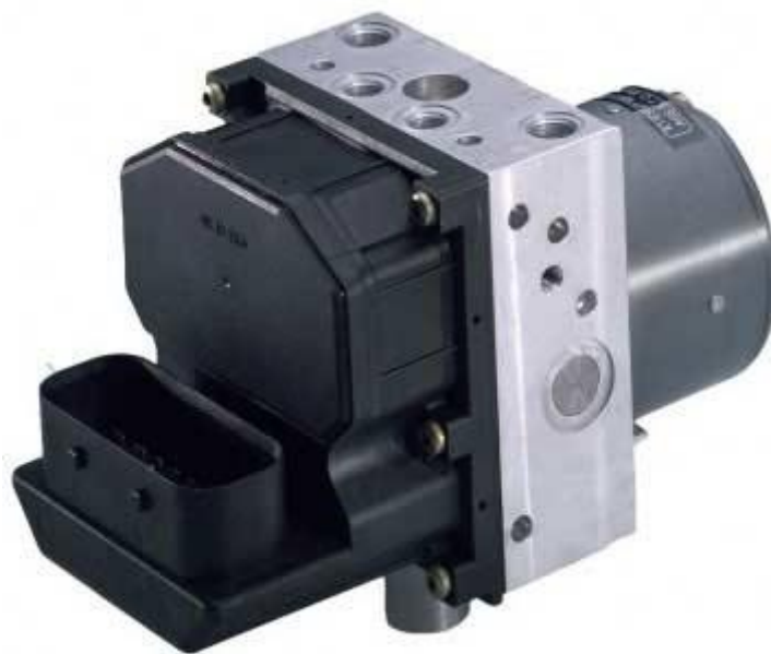
Obrázek 9: řídicí jednotka Bosch 5.7 [32]
