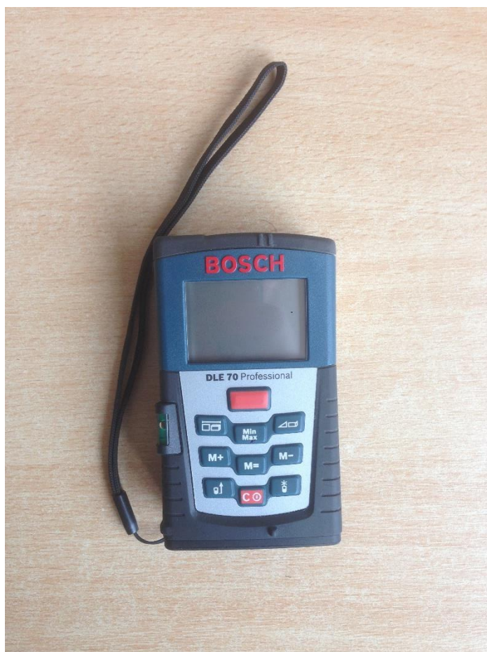
Obrázek 11: Laserový měřič BOSCH DLE 70 Professional
