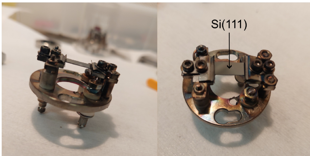
Obrázek 3.2: Paletka sloužící k realizaci ohřevu substrátu průchodem proudu v UHV komoře.
