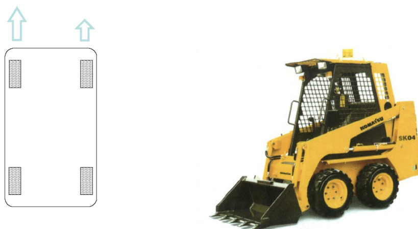
Obr. 10 – Ovládání vozu za pomoci pohonu/brzdění jednotlivých kol (6)
