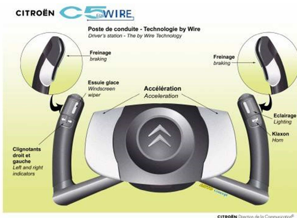
Obr. 27 – Koncept volantu s ovládáním brzd a akcelerace (16)
