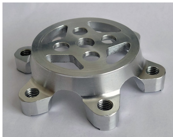
Obr. 4.15 Finální podoba vyrobené příruby náboje zadního kola formulového vozu.
