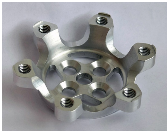
Obr. 4.15 Finální podoba vyrobené příruby náboje zadního kola formulového vozu.
