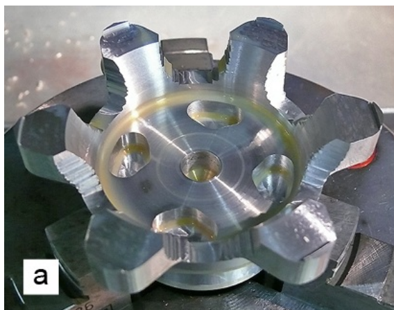
Obr. 4.11 Stav obrobku po a) hrubování kapes, b) zbytkovém dokončení kapes.
