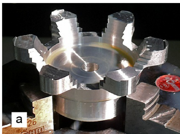
Obr. 4.10 Stav obrobku po a) hrubování bočních drážek, b) zbytkovém hrubování.
