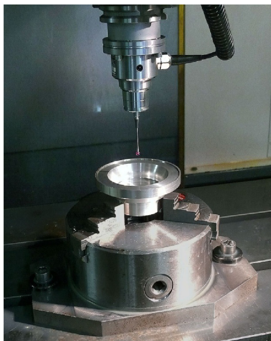
Obr. 4.9 Nastavení nulového bodu obrobku pomocí dotykové sondy Heidenhain TS 220.
