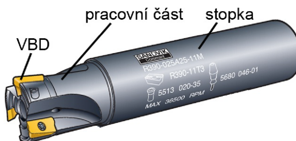
Obr. 1.20 Konstrukce stopkové frézy 13 .
