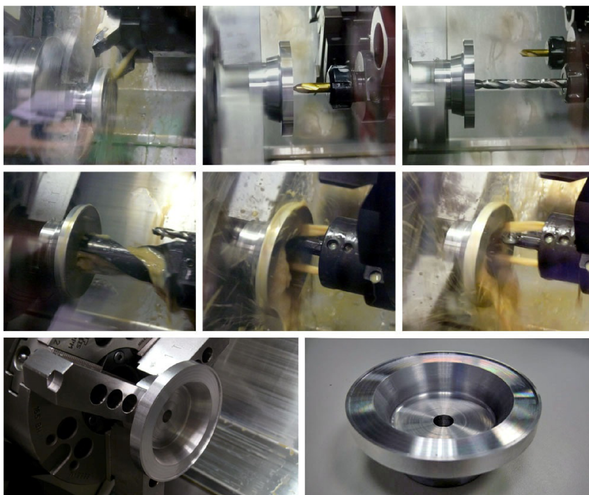
Obr. 4.6 Ukázkové snímky z obráběcího procesu a vyobrazení hotové součásti.
