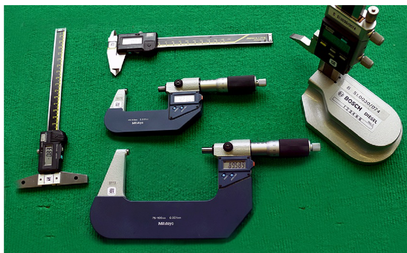
Obr. 4.7 Digitální měřidla značky Mitutoyo použité při výrobě.
