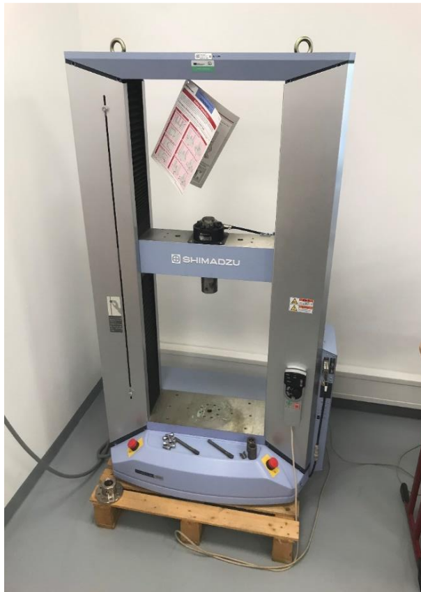
Obrázek 16: Univerzální zkušební stroj Shimadzu AG-X Plus
