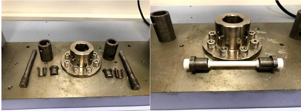
Obrázek 17: Upínací modul, přídržovací pouzdra a aretační čepy
