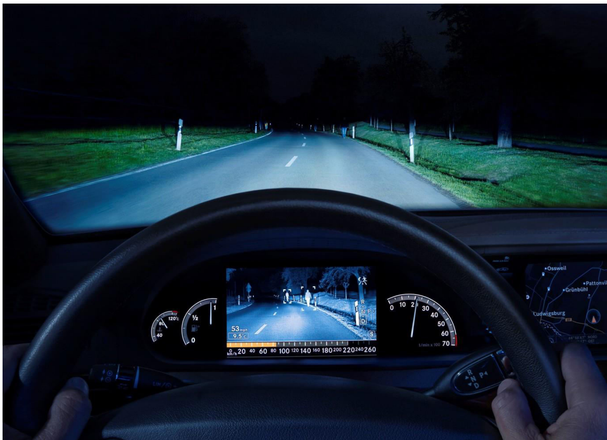
Obrázek 12: Noční vidění od společnosti Bosch – viditelnost chodců na obrazovce Zdroj: http://press.bosch.cz/detail.asp?f_id=773
