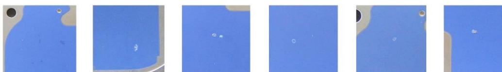
Obr. 11 – Ukázka vad v izolační vrstvě
