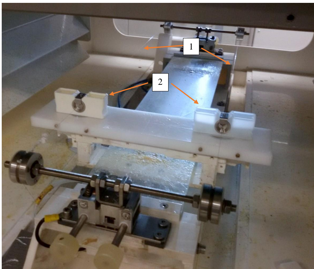
Obrázek 28 Fotografie zachycující upravené strunové zvlákňovací zařízení, které je složeno ze dvou zvlákňovacích strun (1) a dvou pojízdňých zásobníků polymeru s průvlaky (2)
