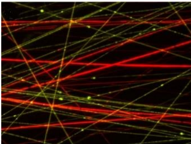
Obrázek 20 Snímek z fluorescenčního mikroskopu zachycující obarvená PCL vlákna (červená) a PEO vlákna (zelená)
