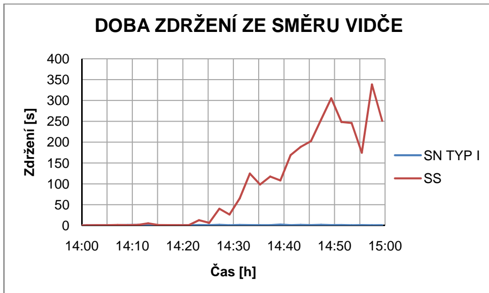
Graf 6-12 Porovnání stávajícího stavu a úpravy signálního plánu ze směru Vidče, odpoledne
