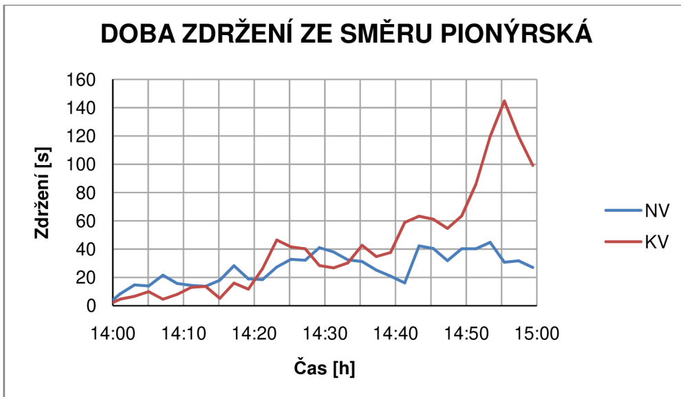
Graf 6-27 Porovnání nového stavu světelně signalizační a okružní křižovatky ze směru Pionýrská, odpoledne
