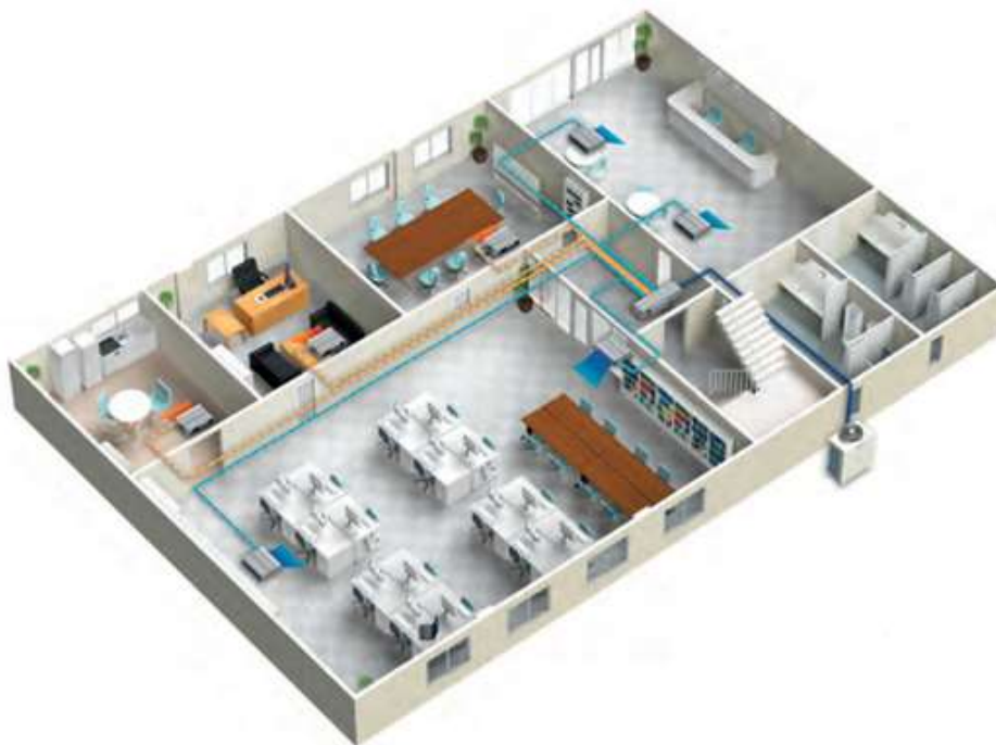
Obrázek 5 Zapojení sestavy dle podkladů výrobce. Tmavě modrá – chladivo, světle modrá – studená voda, oranžová – teplá / topná voda. [8]
