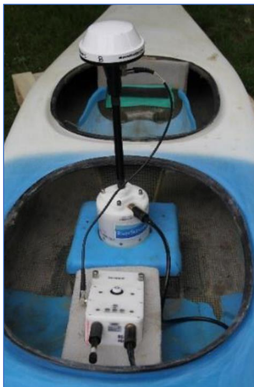
Obrázek 23: Připevnění a stabilizace měřicí aparatury RiverSurveyor M9 na kajaku (Hradilek et al., 2017)
