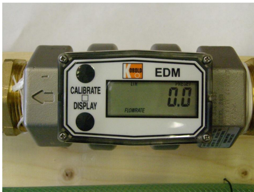
Obr. 17 – Turbínový průtokoměr KOBOLD EDM-4S16
