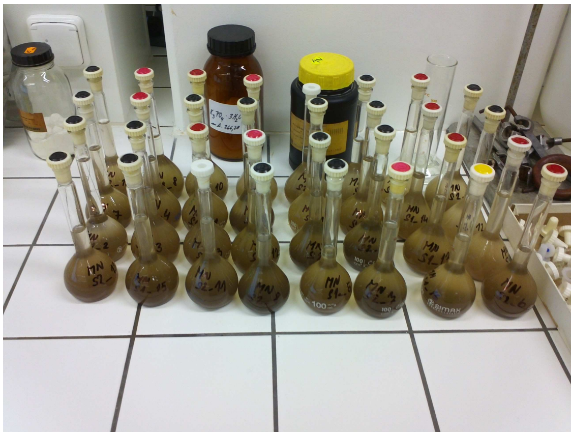
Obrázek 6: Vzorky pro analýzu celkového fosforu, po přidání 5 ml \text{HNO}_3 , povařeni a doplnění po rysku.
