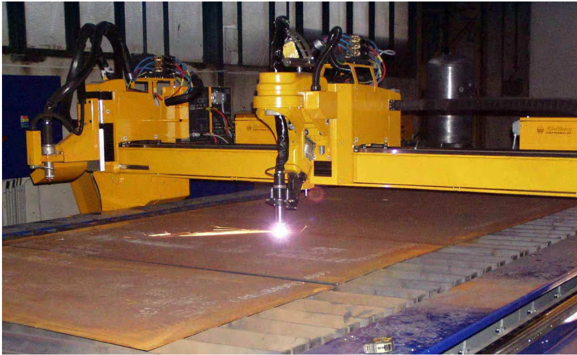
Obr. 6.3 – Plazmové řezací zařízení Fine Focus 1600 od firmy Kjellberg na CNC plazmovém zařízení Microstep MG
