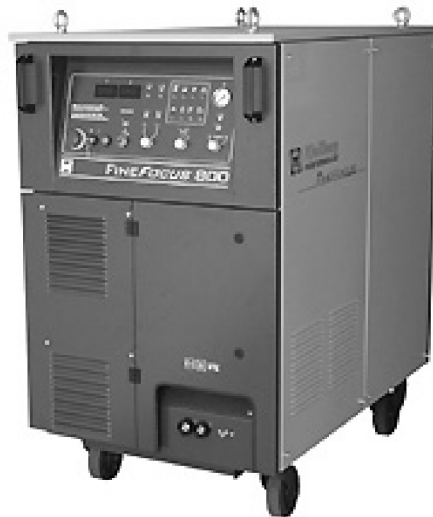
Obr. 6.1 – Plazmový zdroj Fine Focus 800 od firmy Kjellberg [16]
