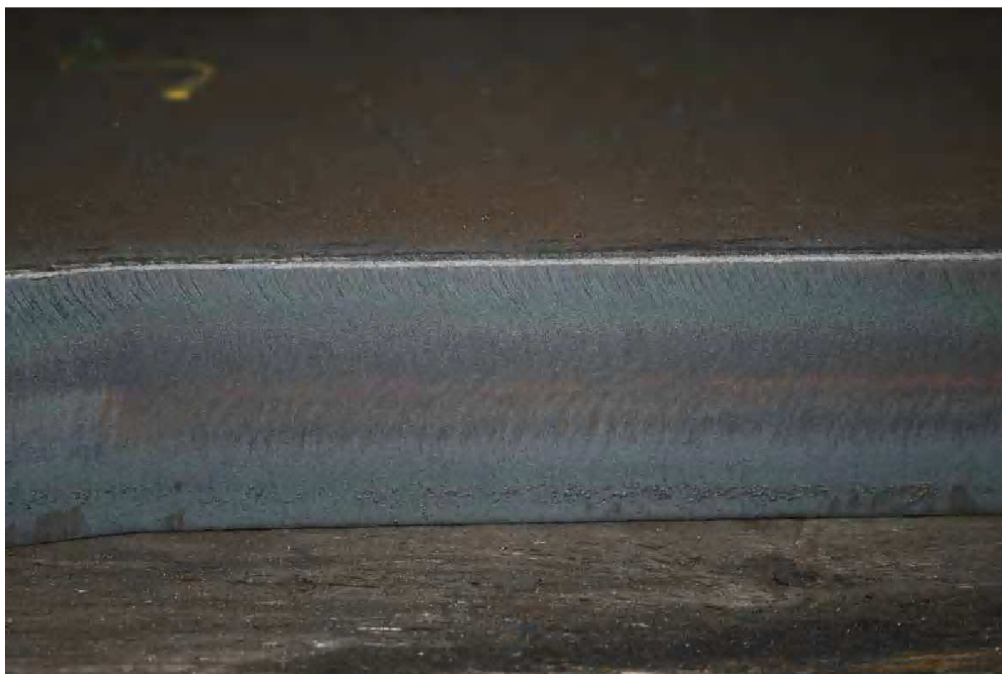
Obr. 6.4 – Ukázka řezné plochy: řez plazmovým zařízením Fine Focus 800, plazmový plyn O_2 , proud 300A, materiál WELDOX 700E tloušťky 50mm.
