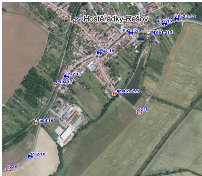
Obr. 6 Vizuální zjištění bodů polohového a výškového bodového pole pomocí serveru ČÚZK [2]
