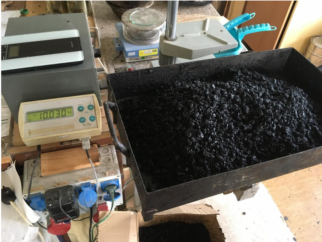
Obrázek 24 Navážení požadované hmotnosti horké asfaltové směsi, následně znovu vrácena do laboratorní sušírny do doby získání minimální teploty pro zhutnění [20]
