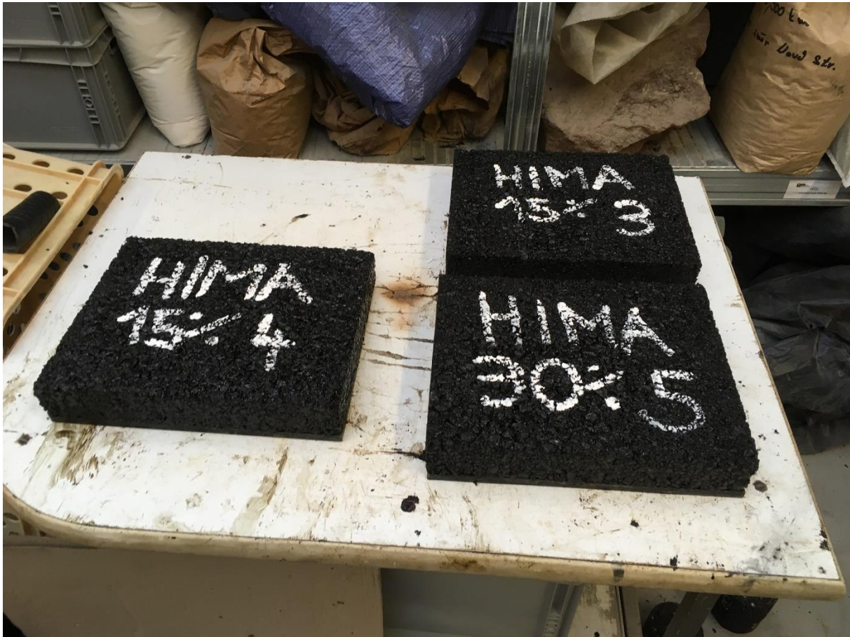
Obrázek 26 Hotové ztuhlé desky popsané procentuálním zastoupením R-materiálu a očíslováním desky [20]
