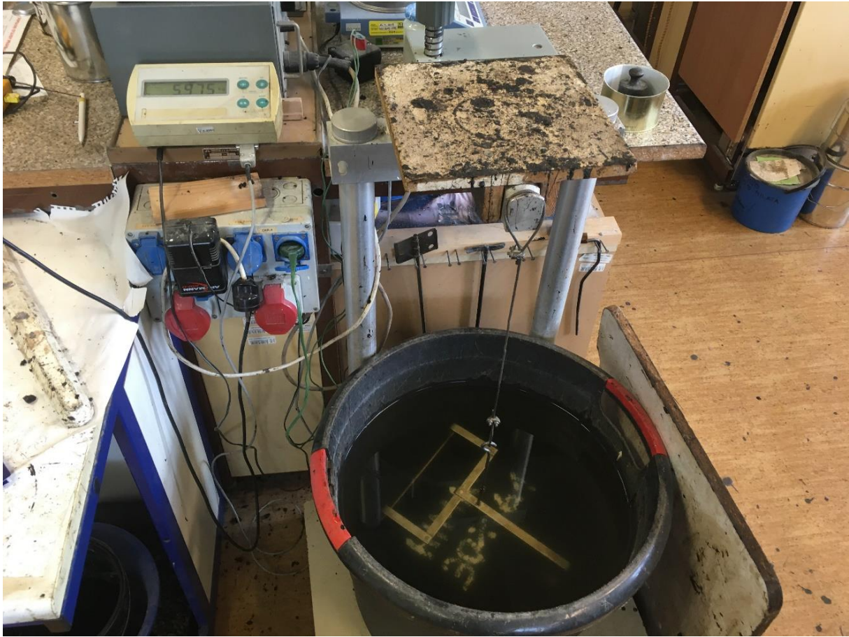
Obrázek 28 Vážení zhutněné desky ponořené ve vodě [20]
