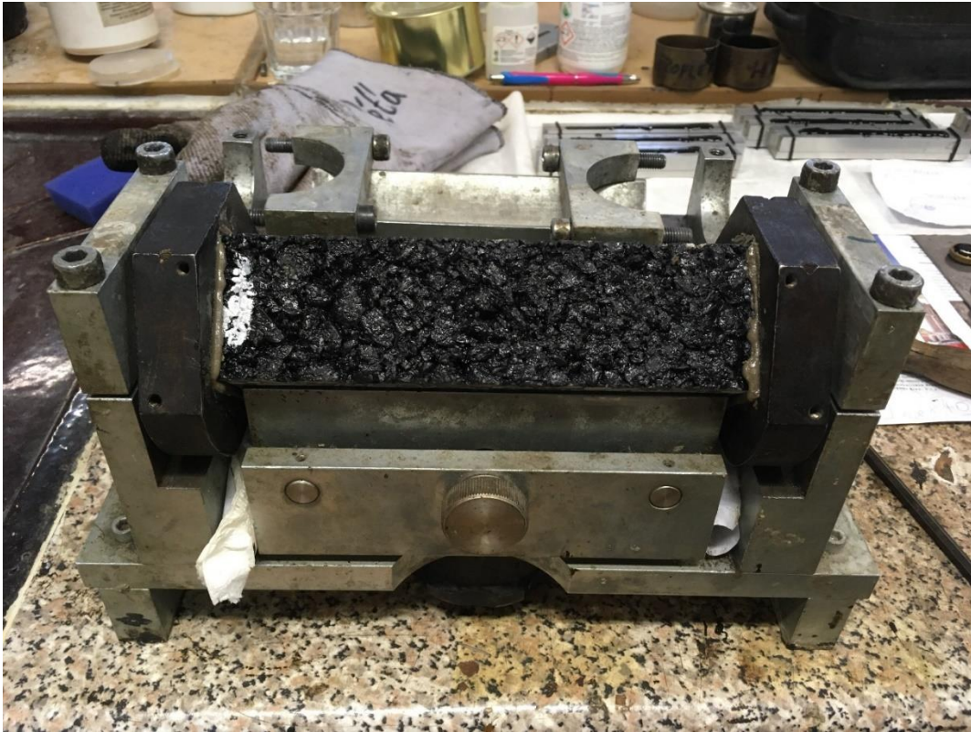
Obrázek 35 Ukázka lepení trámeček do ocelových podložek pomocí dvousložkového lepidla složeného z epoxidu, tvrdidla a vysušené vápencové moučky [20]
