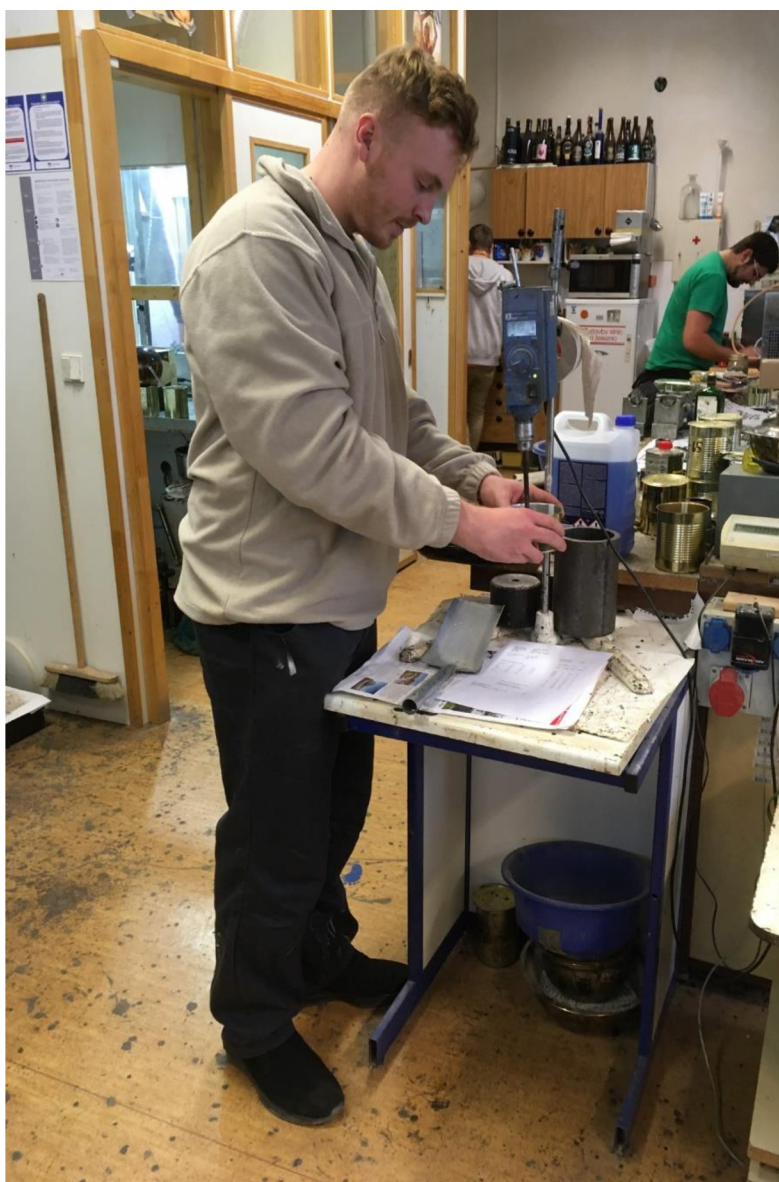
Obrázek 34 Ukázka přípravy dvousložkového lepidla složeného z epoxidu, tvrdidla a vysušené vápencové moučky [20]
