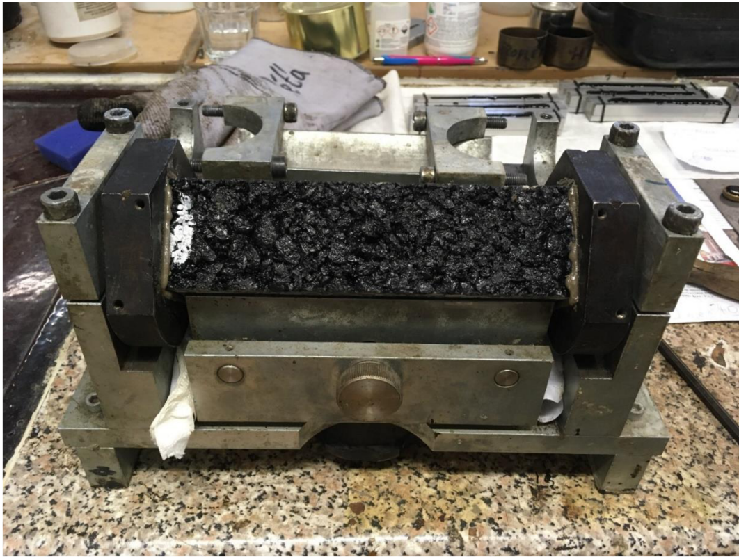
Obrázek 35 Ukázka lepení trámečků do ocelových podložek pomocí dvousložkového lepidla složeného z epoxidu, tvrdidla a vysušené vápencové moučky [20]
