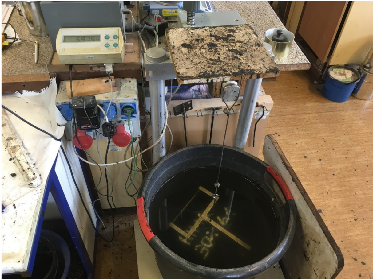
Obrázek 28 Vážení zhutněné desky ponořené ve vodě [20]
