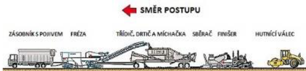
Obrázek 1 Recyklační vlak při technologii recyklace za studena na místě [3]
