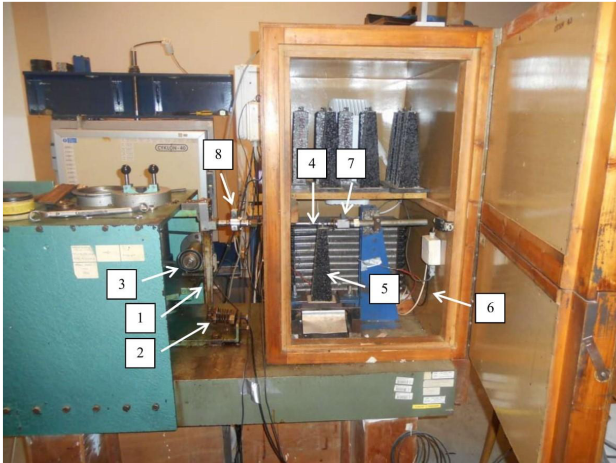
Obrázek 32 Ukázková fotka zkušebního tělesa pro měření modulu tuhosti [18]
