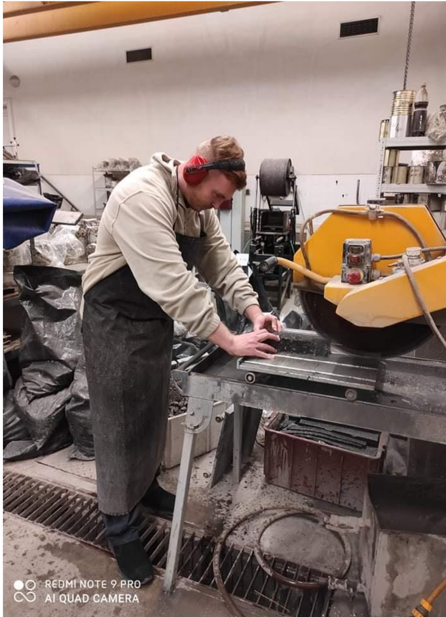
Obrázek 29 Řezání desky na trámečky a trapezoidy [20]
