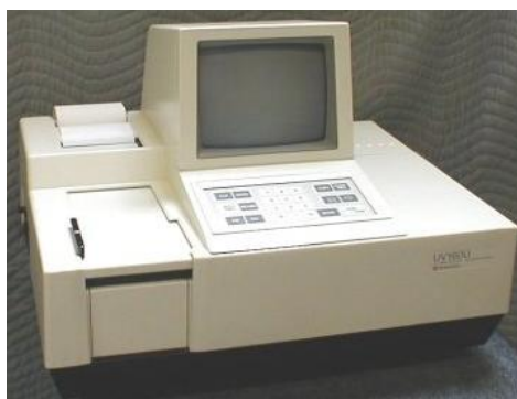
Obr. 4.2: Ilustrativní obrázek spektrofotometru UV - 160 (Shimadzu). Zdroj: internet.
