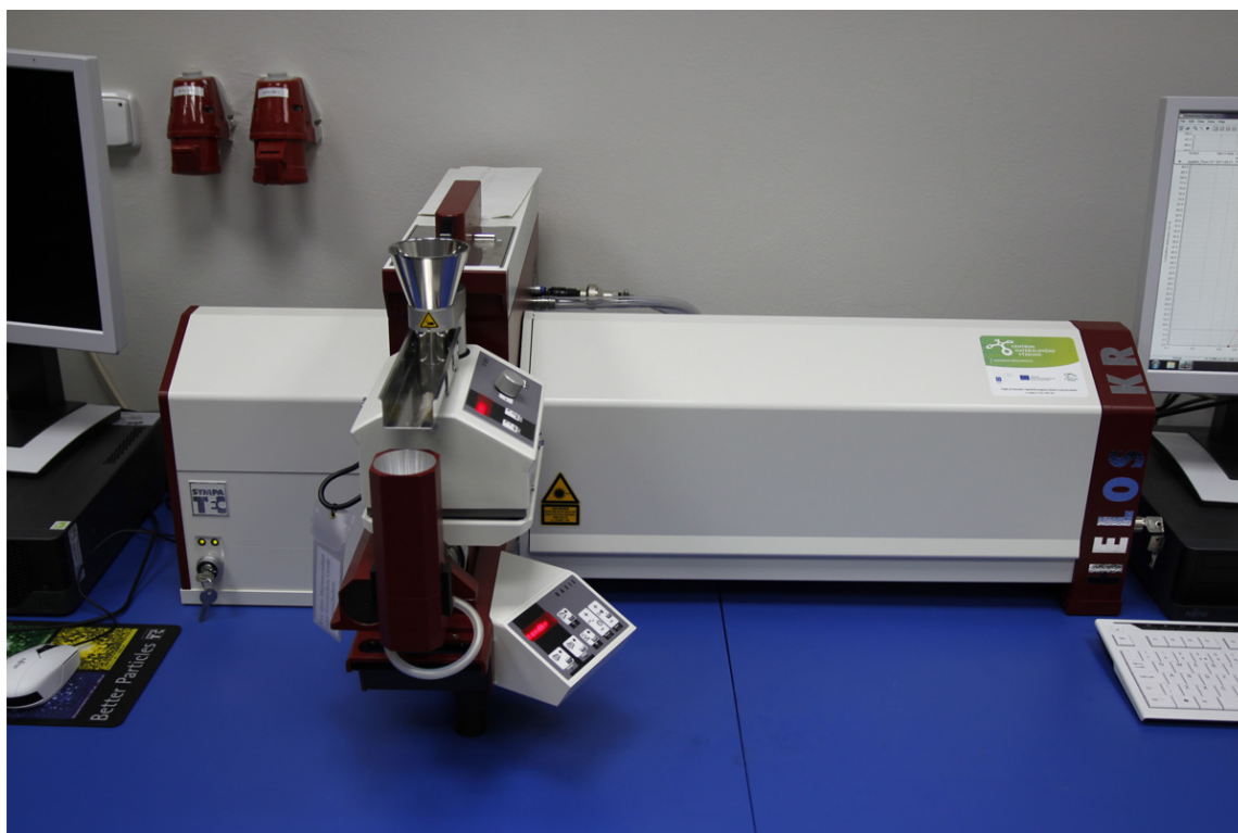
Obrázek 49 Laserový analyzátor velikosti částic Sympatec Helos KR
