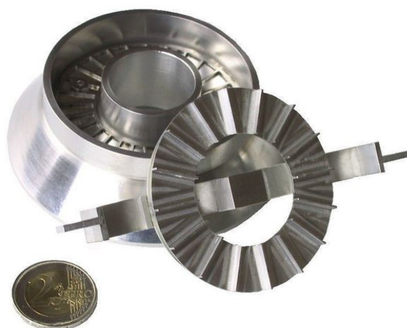
Obrázek 29 Zbrázděný vnitřní povrch smykové cely Schulzova smykového stroje
