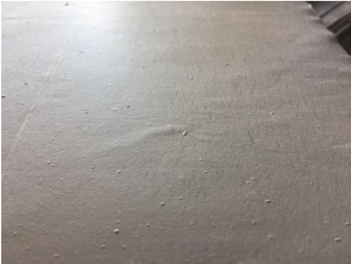
P1 Obrázek 3: Detail nanovláknenné vrstvy PID vyrobené na strunové sběrné elektrodě
