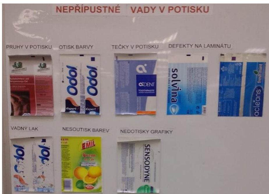
Vzorník nepřipustných vad na provozu Potisk
