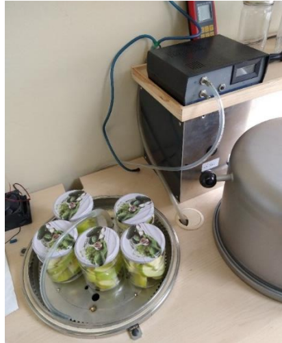
Obrázek 10: Sklenice před ošetřením ve vakuové komoře. Vpravo se nachází poklop, kterým byla následně komora utěsněna (vlastní zdroj).
