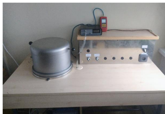
Obrázek 9: Vlevo je znázorněno schéma vakuové aparatury, vpravo je reálný snímek (vlastní zdroj).
