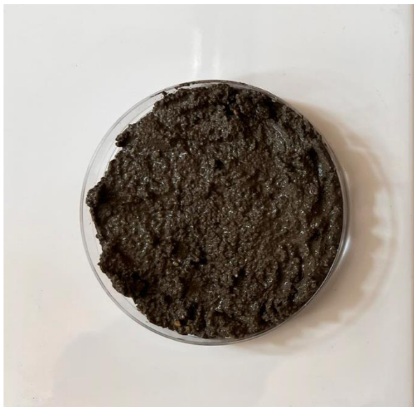
Obrázek 26 Fotografie vzorku betonu v kruhové misce, který tuhnul standardním způsobem po 30 minutách tuhnutí 36
