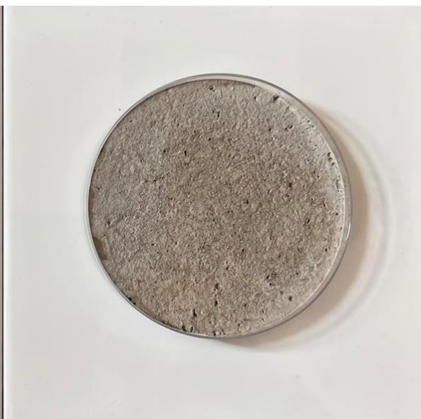
Obrázek 29 Fotografie vzorku betonu v kruhové misce, který byl vystaven mikrovlnnému záření po dobu 60 minut 36
