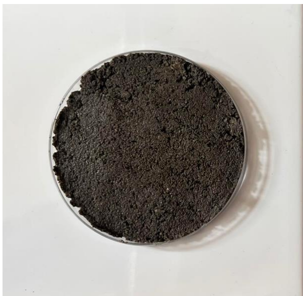
Obrázek 28 Fotografie vzorku betonu v kruhové misce, který tuhnul standardním způsobem po 60 minutách tuhnutí 36
