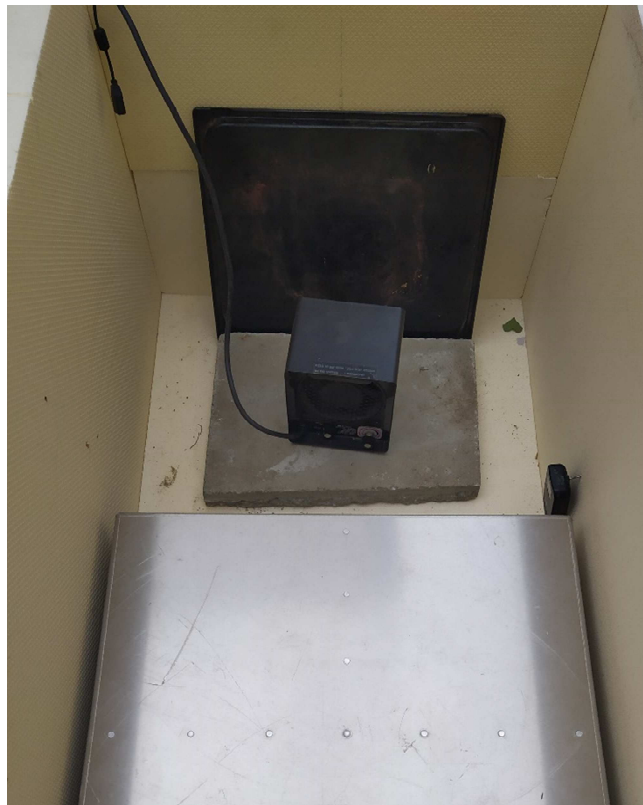
Obr. 29 Soustava pro měření teplotní závislosti měřené hmotnosti
