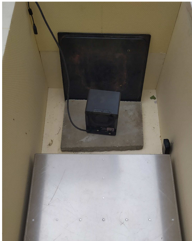
Obr. 29 Soustava pro měření teplotní závislosti měřené hmotnosti
